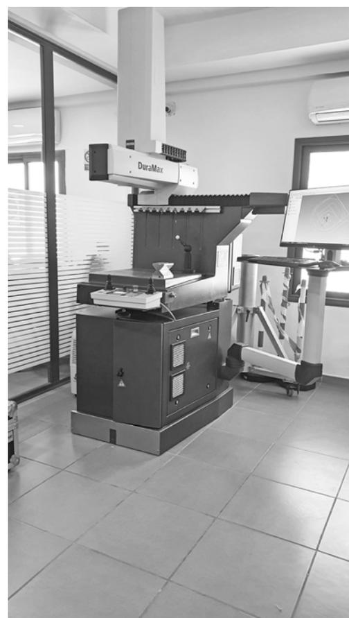
Machine de mesure tridimensionnelle à pont du laboratoire Dimensionnel de MCC
